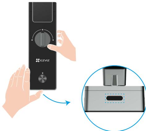
4. Tenere premuto il pulsante IMPOSTA sul pannello posteriore finché la serratura non invia un messaggio vocale e l'indicatore LED inizia a lampeggiare, indicando che la modalità di associazione è stata abilitata.
